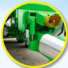
Suspensión hidráulica de la lanza y de los ejes
